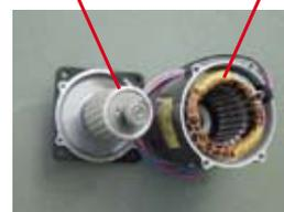
Rotore (magnete permanente)
